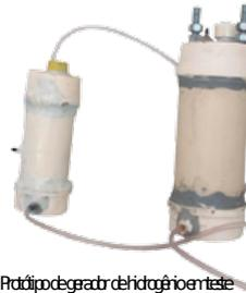
Protótipo de gerador de hidrogênio teste
